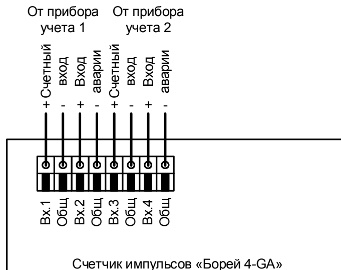
Рисунок А.4 - Схема подключения приборов учета ресурсов к счетчику «Борей 4-GA.EB5»
